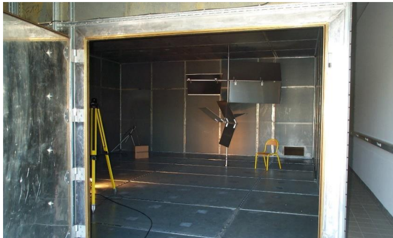
Chambre réverbérante à brassage de modes (dimensions 8,40 m x 6,70 m x 3,50 m 80 MHz - 4 GHz)
