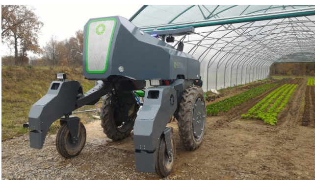
Robot autonome polyvalent réalisant un désherbage mécanique (PUMAgri)
