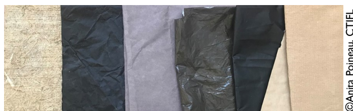
Paillages testés en 2022 au centre CTIFL de Balandran (de gauche à droite : chanvre, papier enduit, papier recyclé, paillage polyéthylène, bicolore enduit, papier kraft).
