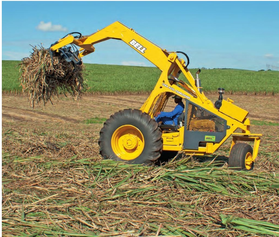
Figure 29 : Photo représentant un cane-loader. C'est une machine avec un bras articulé et une pince au bout pour récupérer les cannes, préalablement mis en tas par le producteur (source : docplayer.fr).
